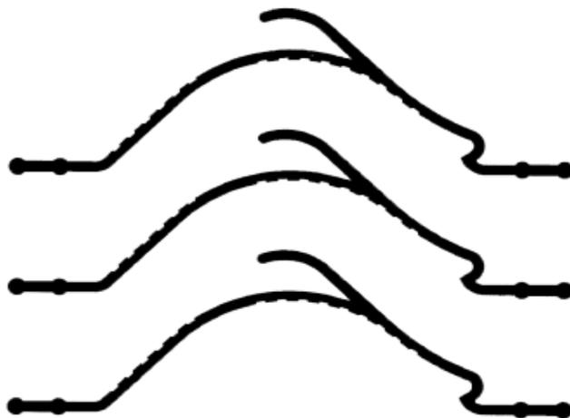
Каплеуловитель Т 400 используется в потоке после катушек теплообменника при скорости потока от 2 до 4 м/с.
