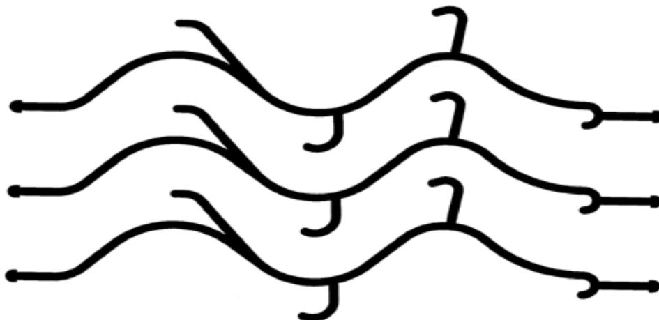
Каплеуловитель Т 200 наиболее часто используется в увлажнителях при скорости потока 1,5-4 м/с.
