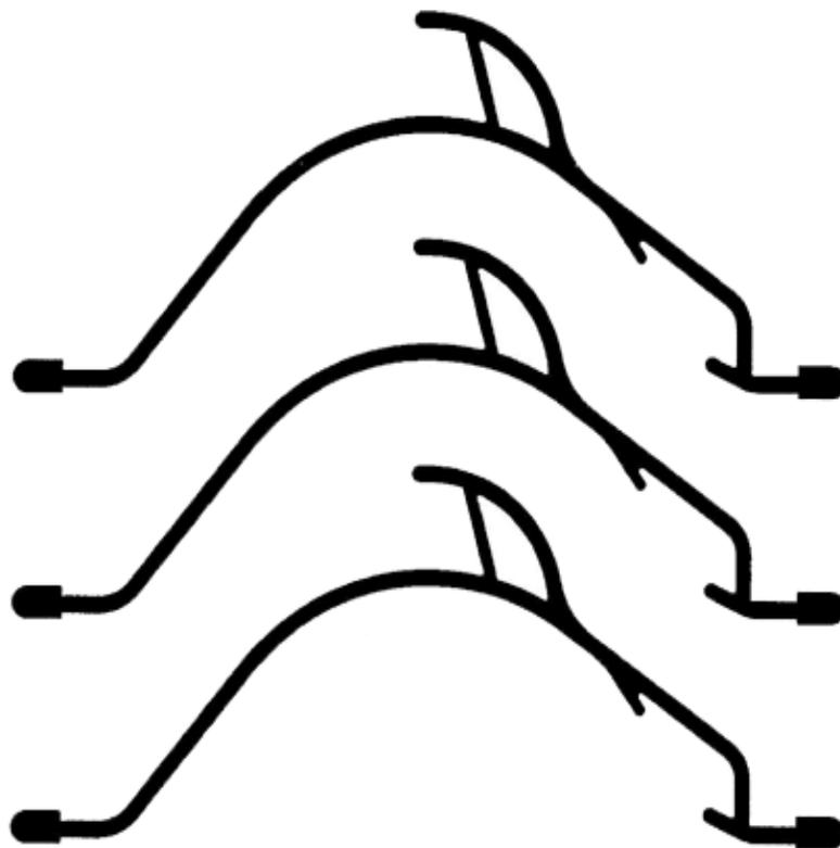
Каплеуловитель Т 500 используется в охладителях теплообменника при высоких температурах и потоке воздуха 2-5 м/с.
