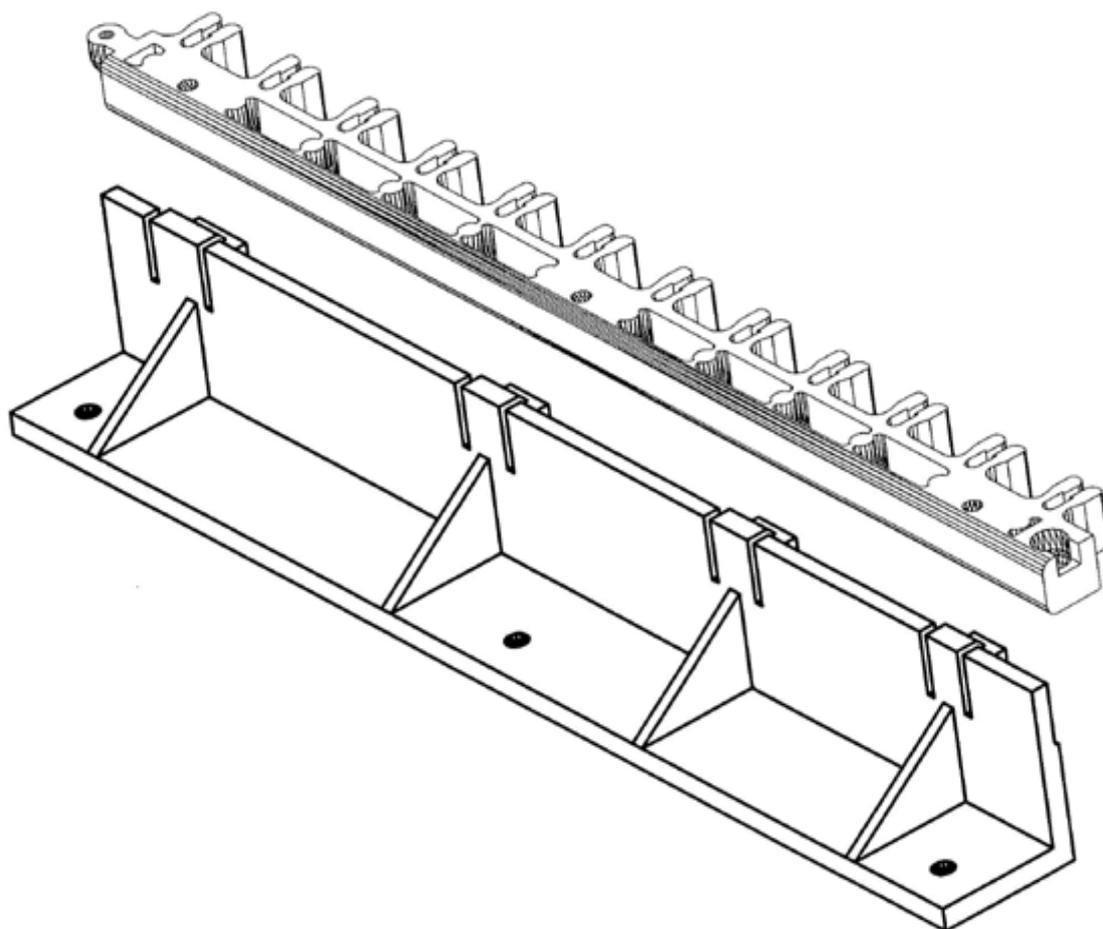
Монтажный профиль: предназначен для крепления направляющих профилей каплеуловителя всех типоразмеров (25 мм., 30 мм., 33 мм.).
